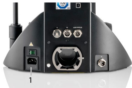
Fig. 58 Módulo de fusibles
