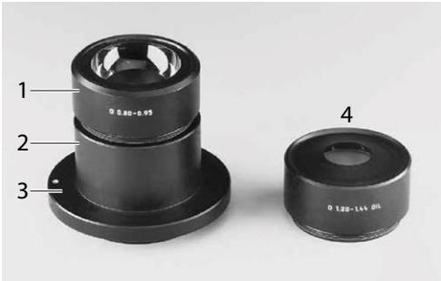
Fig. 48 Condensadores de campo oscuro
