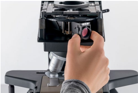
Fig. 22 Montaje del bloque de filtros
