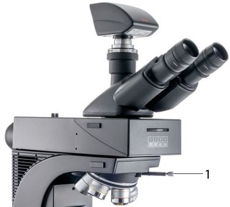
Fig. 34 Prisma del condensador
