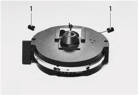
Fig. 33 Centrado del anillo de luz (es decir, condensador UCA/P)
