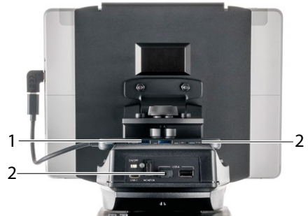
Fig. 13 Conexiones del concentrador USB
