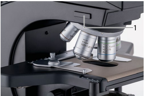
Fig. 49 Analizador/polarizador 1 Alojamiento para analizador
