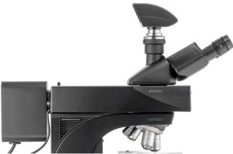
Fig. 53 Iluminación de fluorescencia con cambiador de bloque de filtros, obturador, diafragma de campo y diafragma de apertura
