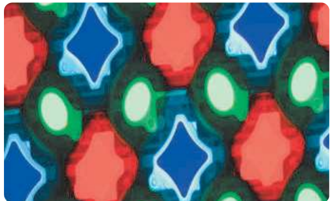
Píxeles RGB de una pantalla OLED.
