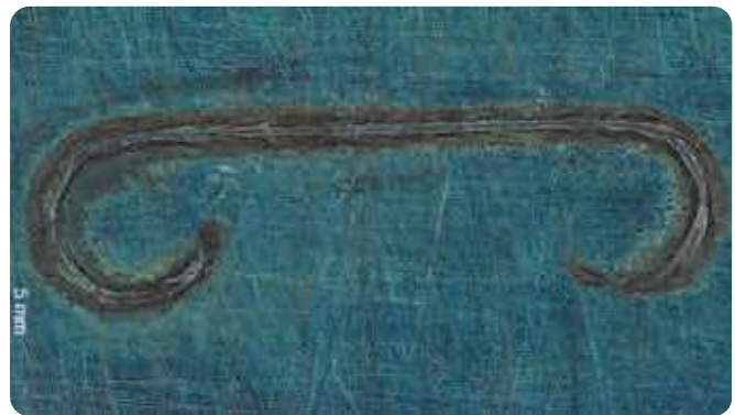
Imagen de una pieza soldada por láser que podría utilizarse en una carrocería de vehículo eléctrico.
