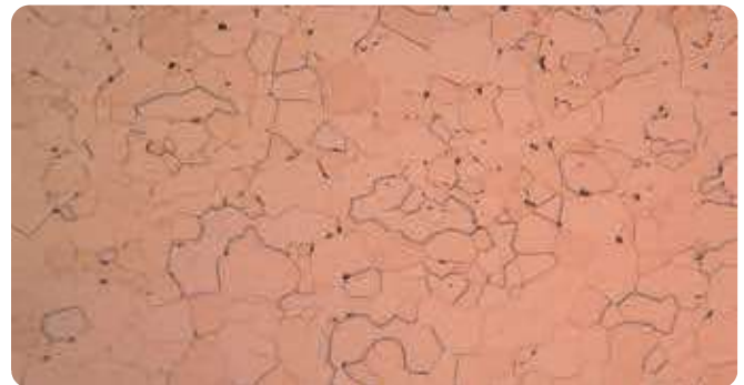
Microestructura de grano de un acero al silicio.
